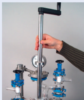
Height adjustable stirrer for optimal loosening, pressing and flattening of filter cake Höhenverstellbarer Rührer für optimales lockern, anpressen und streichen des Filterkuchens
